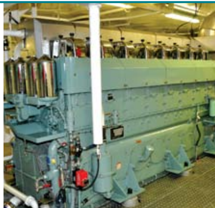
Die Mitsubishi-Hauptmaschine des EVENTUS leistet 1.343 kW | Bilder: Grohmann
